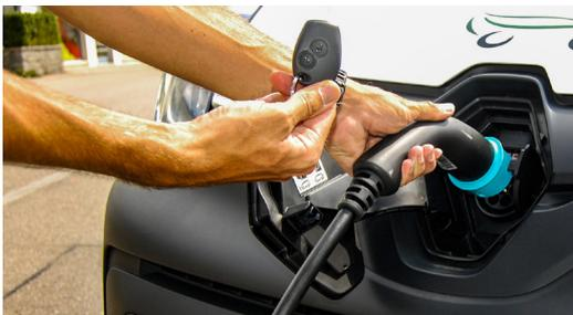
Vor Fahrtantritt ist das Ladekabel von der Ladesäule zu trennen und in das Fahrzeug, bzw... den Kofferraum zu legen. Dazu den Öffnen-Knopf an der Fernbedienung drücken und das Kabel aus dem Fahrzeug ziehen. Anschliessend das Ladekabel im Fahrzeug verstauen.
