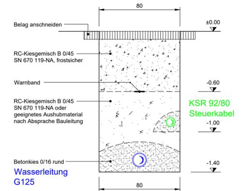
Je nach Standfestigkeit der Grabenwand muss in Absprache mit der Bauleitung gespritzt werden.
