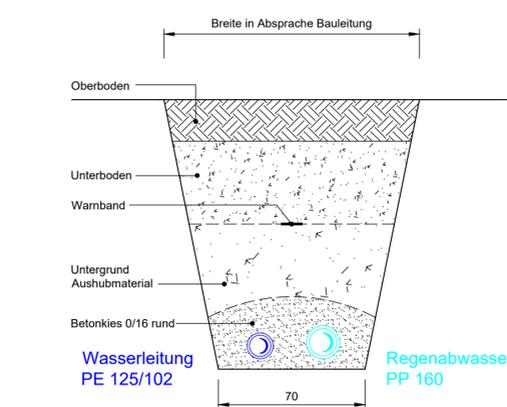
Je nach Standfestigkeit des Bodens muss die Böschung in Absprache mit der Bauleitung angepasst werden.
