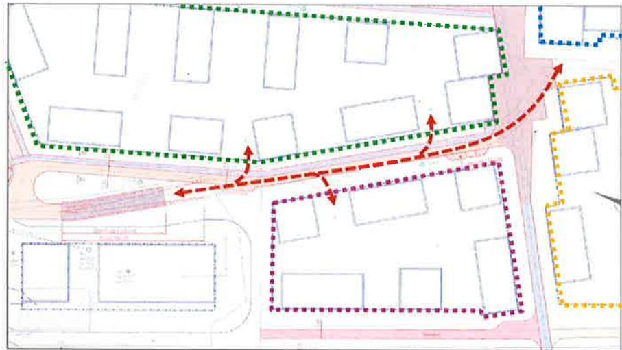
Abb. 26: Unterirdische Erschliessungsstrasse mit Anschlüssen an private Tiefgaragen, Quelle Hintergrund: dsp Ingenieure + Partner AG, Stand: 21.06.2022
