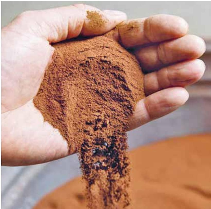
Phosphorhaltige Klärschlammasche nach Verbrennung des zentral verwerteten Klärschlamm; sie ist die Basis für die Phosphorrückgewinnung im Phosphor Mining.
