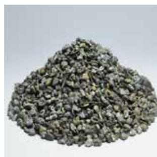
Wertvolle NE-Nichteisen-Metalle (5–8 mm) direkt aus dem Separationsprozess.
